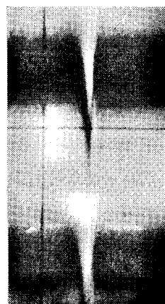
図 3. 光弾性によって観測されたイオン交換ガラスの応力分布 Stress distribution profiles of ion-exchanged glasses observed by photo-elastic technique
