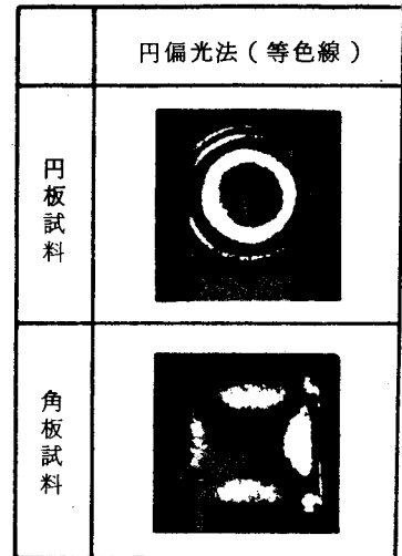
図8 円偏光法による強化ガラスの観察例
