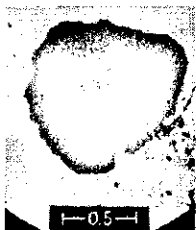
図 10. 表面失透——クリスト パライト放射状集合体
