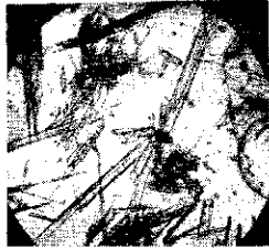
図 8. 板状および柱状晶の集合 (恐らく \beta -ウォラストナイト) 通常光
